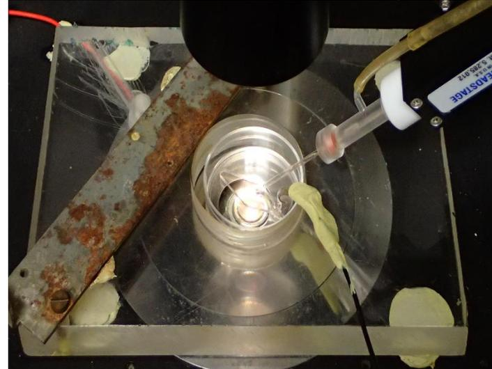
Micropipette et électrode dans suspension
