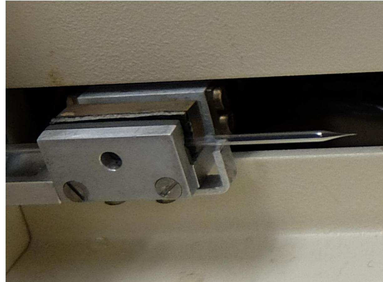
Micropipette étirée et coupée à chaud (Etireuse programmable)
