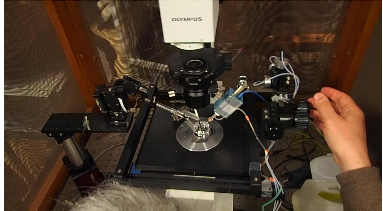
Descente de la micropipette avec le micromanipulateur
